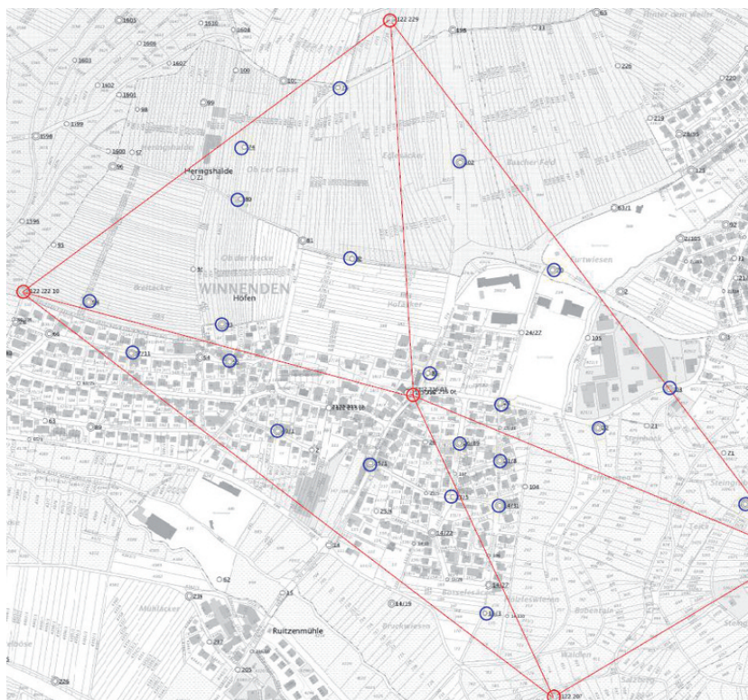
Abb. 23: Beispiel zur Passpunktauswahl - TP-Masche
